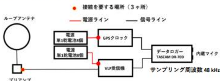
第1図: 観測器機の構成。(左) 構成図、(右) 観測地における器機の設置状況 (JAXA提供)。黄丸はアンテナ。
