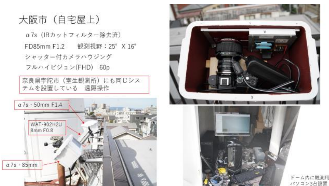
図1 観測システム \alpha 7s (IR カットフィルター除去済み) FD85mm F1.2
