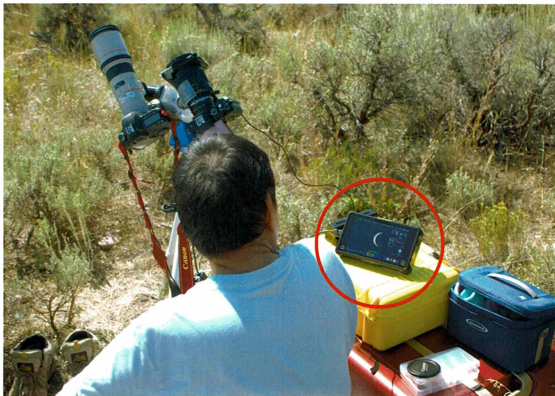
写真-1 外部レコーダー
